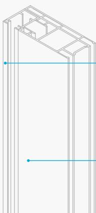
Vodící profil STF1 (vyjímatelný) / Guiding rail STF1 (removable) / Führungsschiene STF1 (entnehmbar) / Coulisse STF1 (détachable) / Perfil de guía STF1 (extraíble) / Profilo di guida STF1 (rimovibile) / STF1 vezetőprofil (cserélhető)
