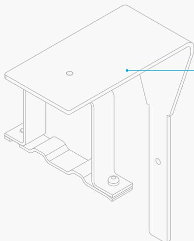
Nosný držák STF bez krytu / Bearing STF holder without cover / Tragender STF-Halter ohne Abdeckung / Console STF sans lambrequin / Soporte portante STF sin cubierta / Staffa portante STF senza copertura / Takarólemez nélküli STF tartókonzol
