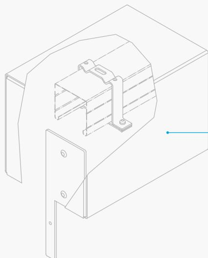
Krycí plech s nosným držákem STF / Cover sheet with bearing
