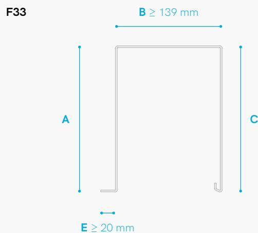
\* tloušťka krycích plechů 2 mm / cover sheet thickness 2mm / Stärke der Blende 2 mm / épaisseur des capots 2 mm / grosor de la chapa de cubierta 2 mm / spessore delle piastre di copertura 2 mm / a takarólemezek vastagsága 2 mm
