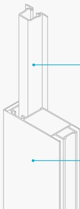
\* Plastový zapuštěný profil / Plastic recessed profile / Eingelassene Kunststoffschiene / Profilé en plastique encastré / Perfil de plástico empotrado / Profilo in plastica a incasso / Műanyag süllyesztett profil
